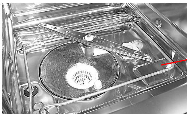
Abb. 1 – Beispielhafte Innenansicht des Spülraums; Detail der Heizwiderstände.
