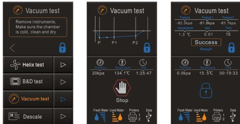
In Übereinstimmung mit EN 13060 erfordert der Test, dass die Leckluftrate kleiner oder gleich 0,13 kPa/min ist. Während 10 Minuten:
