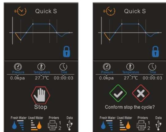
Wenn der Zyklus manuell unterbrochen wird, nachdem er die Trocknungsphase erreicht hat, können die Gegenstände im Inneren des Sterilisators als steril angesehen werden. Hinweis: In Anbetracht der Tatsache, dass der Zyklus während der Trocknungsphase unterbrochen wurde, können die Materialien und Instrumente im Inneren der Kammer nass sein
